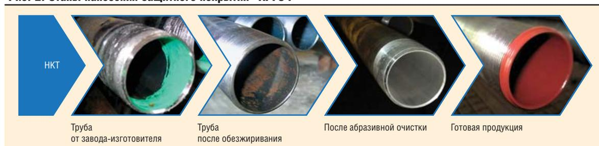
Рис. 3. Изготовление НКТВ
